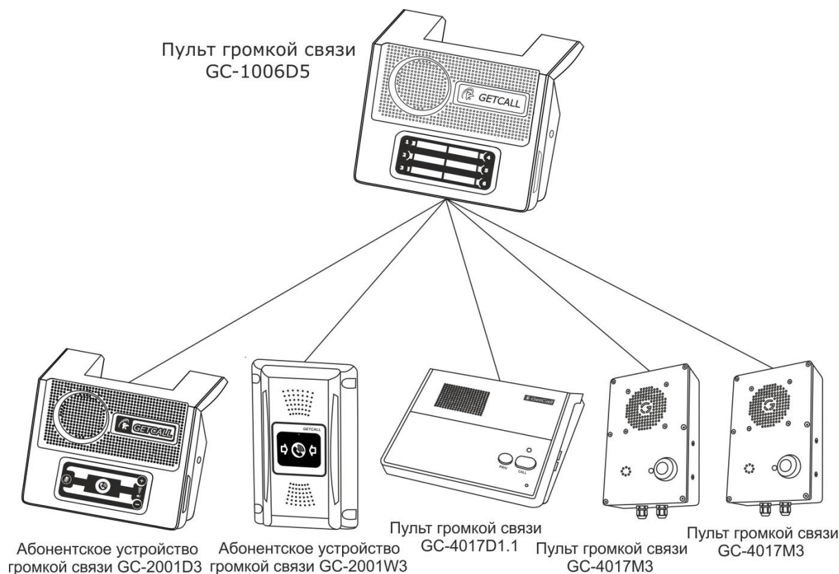
Рисунок 3. Структурная схема комбинированной системы связи
