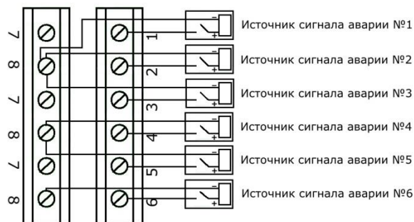
Рисунок 6. Подключение сигнальных линий при использовании подачи напряжения
