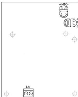
Рисунок 2. Внешний вид платы абонентского устройства громкой связи GC-2001W3
