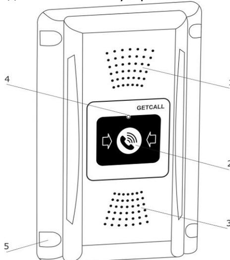
Рисунок 1. Внешний вид абонентского устройства громкой связи GC-2001W3
