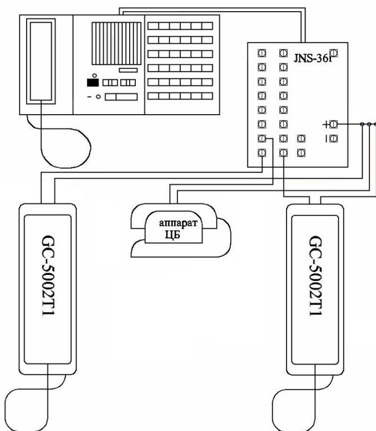
Рисунок 3. Схема подключения абонентских устройств к пультам громкой связи серии GC-1036D
