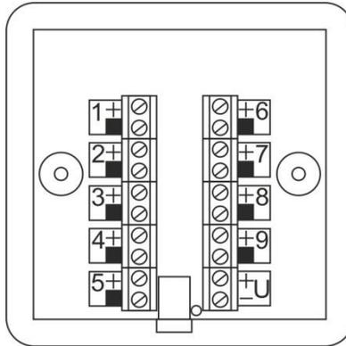
Рисунок 4. Внешний вид коммутационной коробки при снятой крышке
