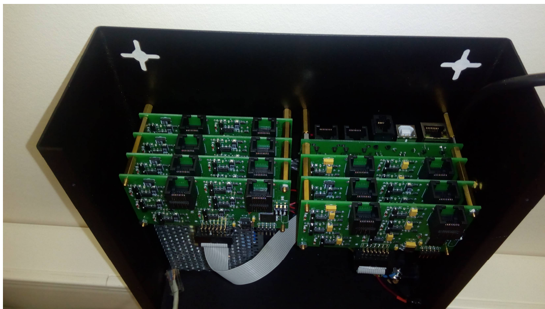
Рисунок 5.8. Базовый блок коммутации GC-7420K0
