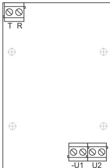
Рисунок 2. Внешний вид платы приставки дублирования сигнала вызова GC-0001D1
